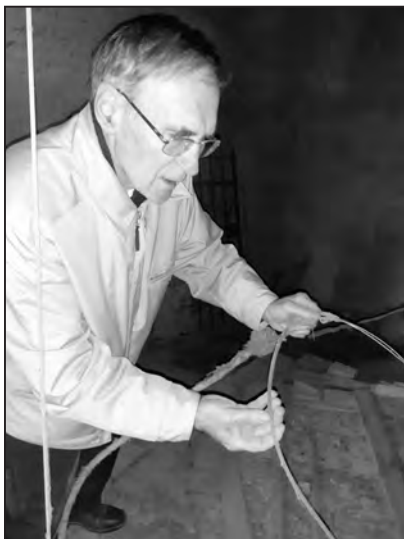
Ing. Léner pokazuje oštećenu žicu za potezanje koju je morao zamijeniti
